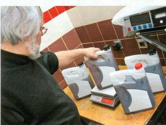
Масса залитого масла определялась путем взвешивания канистры до и после заливки
