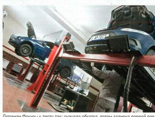
Готовили Фокусы к тесту так: сначала обкатка, потом заливка первой порции тестового масла, затем четверть часа работы на холостом ходу — и сразу вторая замена, чтобы «отмыться» от следов «конвейерного» масла
