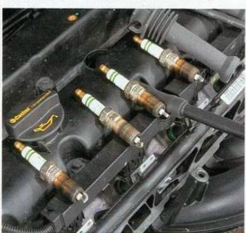
Высокое качество бензина и отсутствие технических проблем косвенно подтверждалось состоянием свечей зажигания после теста у всех восьми автомобилей
