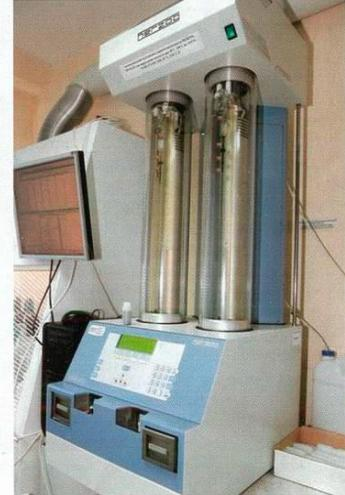
Автоматический мультиаппаратный вискозиметр Herzog HVM 472 определяет кинематическую вязкость при 40°C и 100°C. Для анализа одной пробы ему требуется всего 12 минут и 20 мл масла
