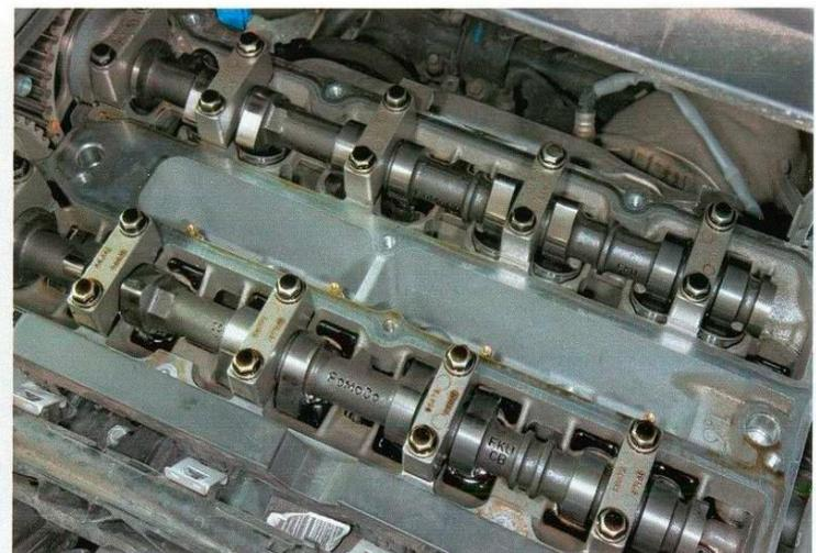
Головка блока после 10000 км ускоренных испытаний. У всех восьми автомобилей — образцовая чистота и отсутствие малейших следов износа кулачков распределителей
