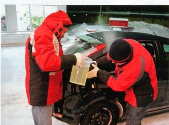
При контрольной заливке топлива в начале, середине и конце теста автомобили дозаправляли до полностью заправленного бака с помощью таких вот «мензурок». В остальное время — до «отсечки» пистолета. При расчете среднего расхода общее количество израсходованного топлива делилось на пробег
