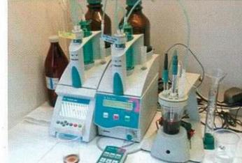
Щелочное число определяют в лаборатории с помощью автоматического титратора CRISON Compact
