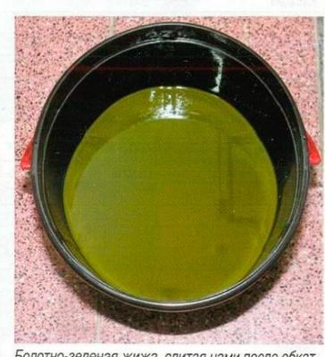
Болотно-зеленая жижа, слитая нами после обкатки, — это заводская «полусинтетика» конвейерной заливки Ford Formula F, которую делает Castrol
