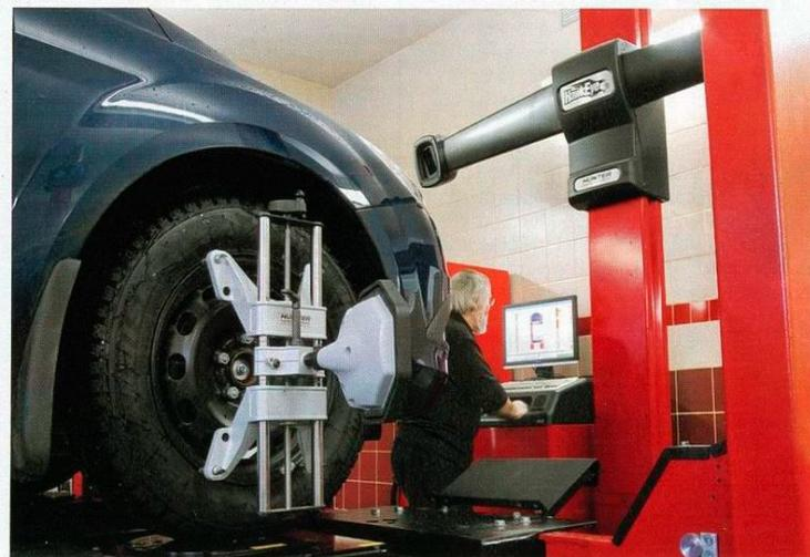
Углы установки колес контролировались не только после происшествий на дороге — такой проверке на нашем стенде Hunter Engineering в полигоновском техцентре АвтоРевю автомобили подвергались каждые 5000 км
